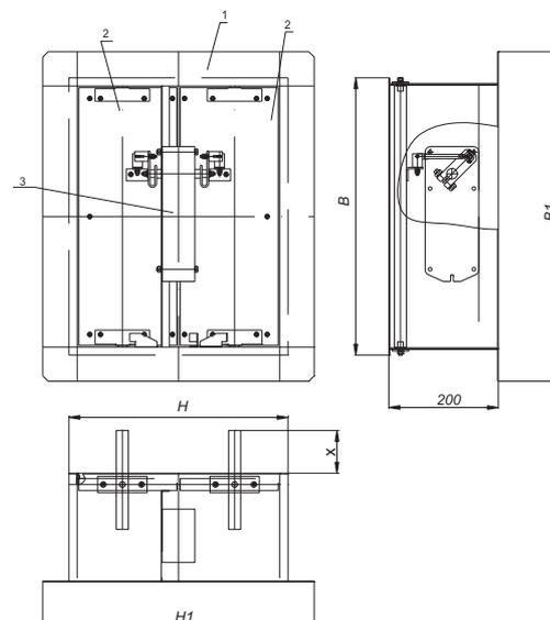
**ВЫЛЕТ ЗАСЛОНКИ ЗА КОРПУС КЛАПАНА КПС-1м(90)-МС С ПРИВОДОМ СНАРУЖИ**
