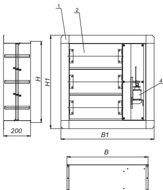
Клапан КДМ-3-СЛ электромеханическим приводом
