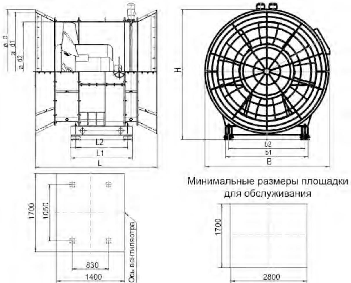
Рис. 8. Габаритные и присоединительные размеры вентиляторов осевых BOM-14.
