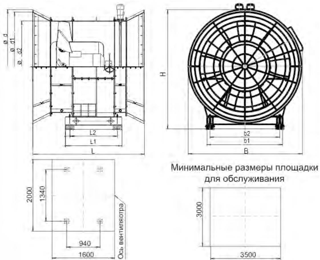
Рис. 10. Габаритные и присоединительные размеры вентиляторов осевых ВОМ-18.
