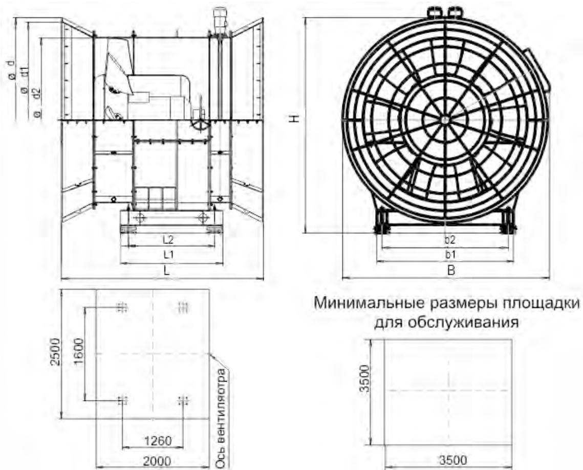
Рис. 11. Габаритные и присоединительные размеры вентиляторов осевых BOM-20.
