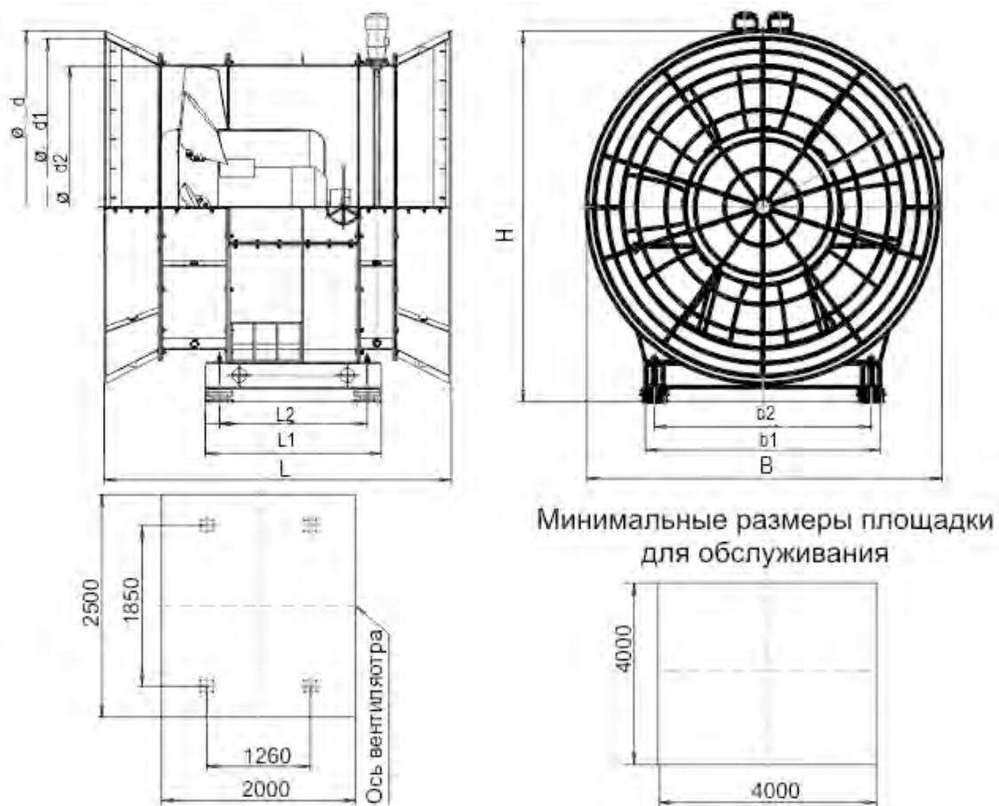
Рис. 12. Габаритные и присоединительные размеры вентиляторов осевых BOM-24.
