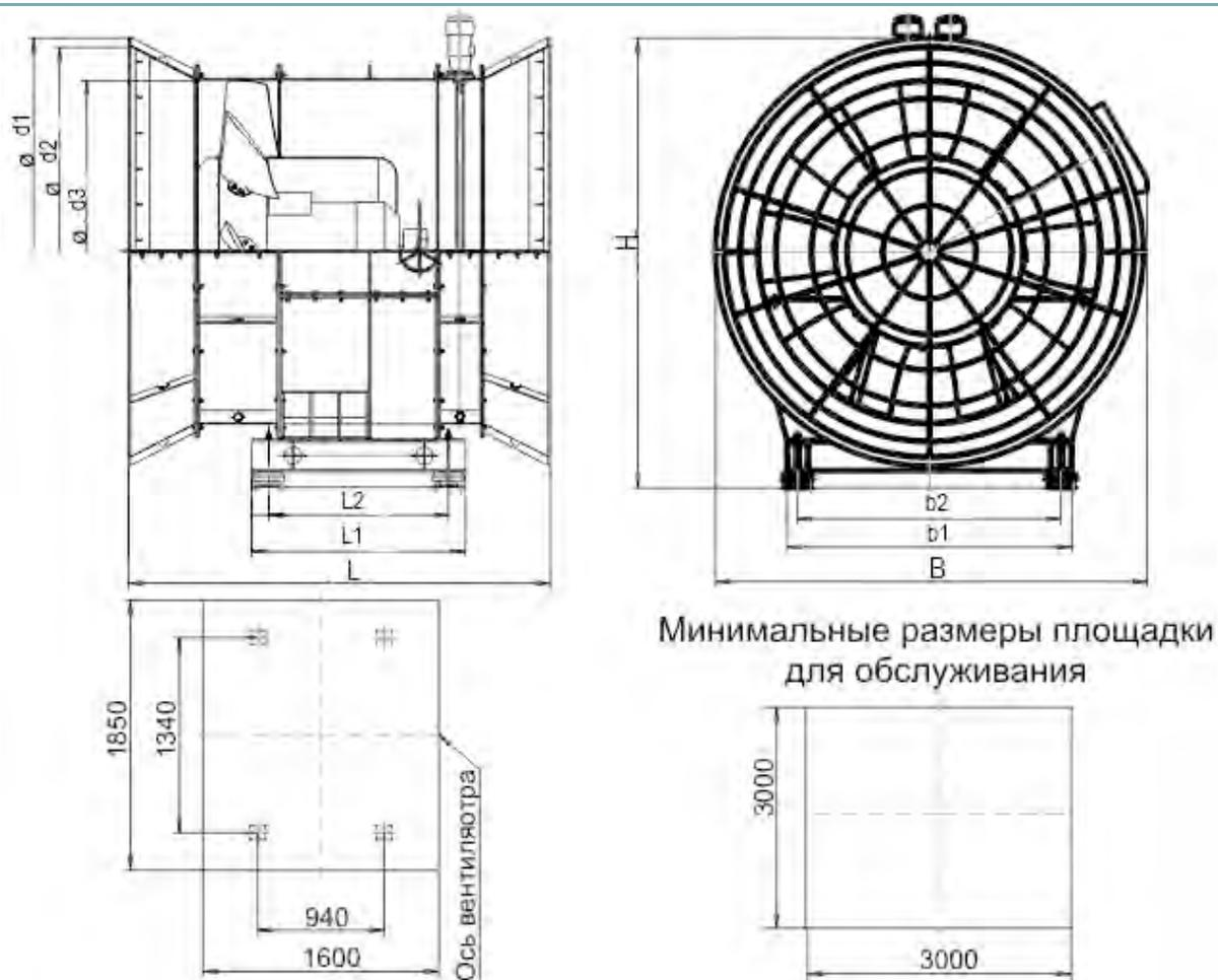
Рис. 9. Габаритные и присоединительные размеры вентиляторов осевых ВОМ-16.
