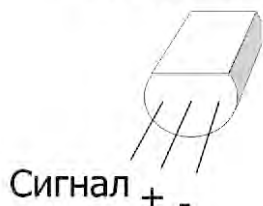
Рис. 85. Схема подключения датчиков.
